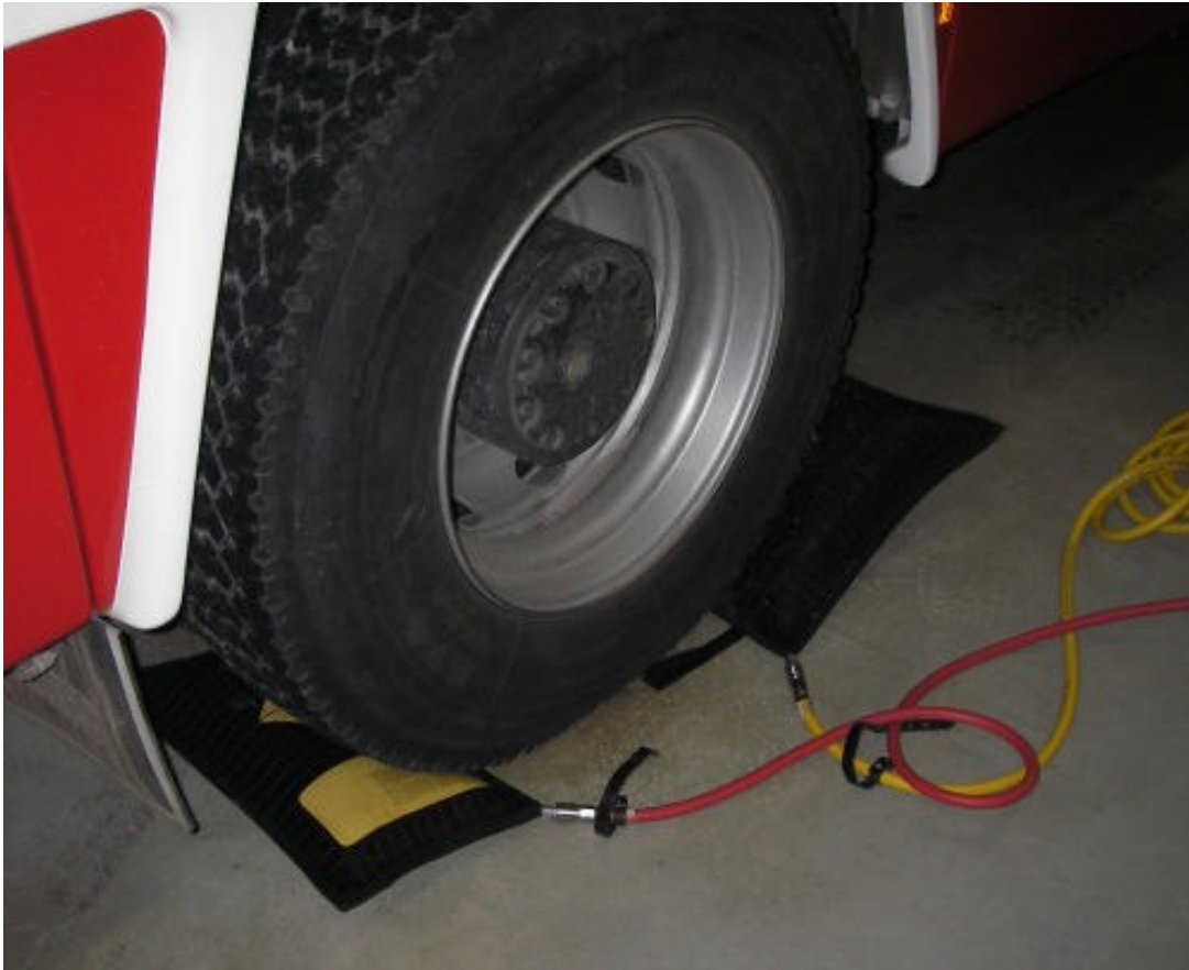
Hebekissen mit verschiedenfarbigen Druckschläuchen.
