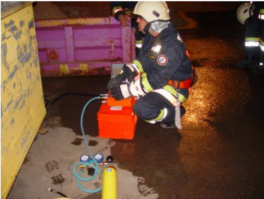
Hebekissen werden mit der Druckluftflasche mit Druckreduzierventil gespiesen und mit einer Steuerarmatur bedient.
